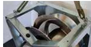
Montage von Hebeösen an dafür vorgesehenen Stellen
