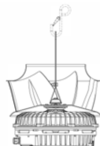
1. Sollevatore – 2. Vite di sicurezza – 3. Dado di sicurezza
