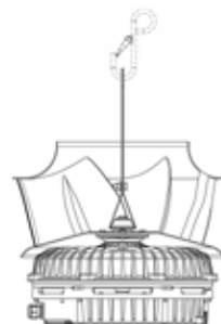
1. Ayuda de elevación 2. Tornillo de seguridad 3. Tuerca de seguridad
