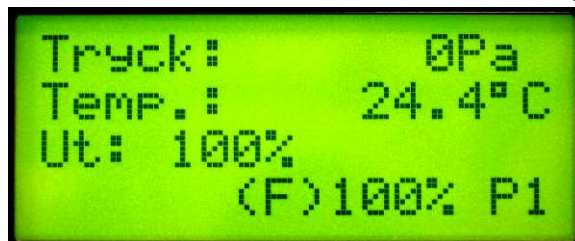
Figur 10. FKP-R informationsskärm i tryckreglerat läge med utetemperaturkompensering och aktivt veckoschema där program P1 körs med 100% av tryckbörvärdet. F:et visar att driften går i forcerat läge.
