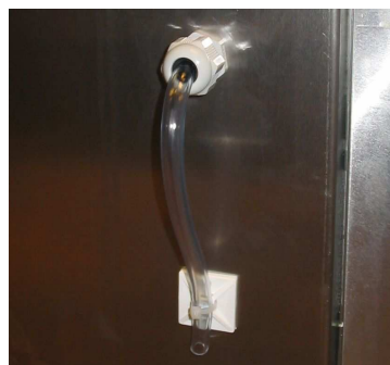
Figur 5. Montering av tryckslang för mätning av atmosfärstrycket.
