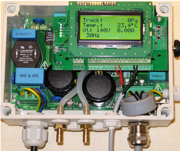
Figur 3. Elektrisk och mekanisk inkoppling av FKP-M i normal fläktapplikation med ferritring på utgående motorfaser. Byglad för rotationsriktning framåt och utetemperatursensor på terminal 9,10.
